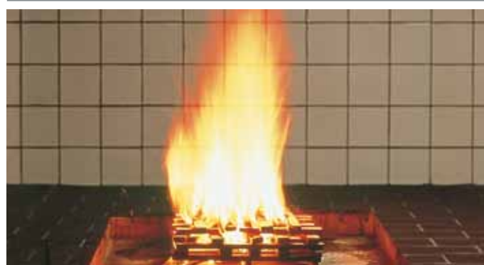
Incendiul-test TF 1: arderea deschisă a lemnului
